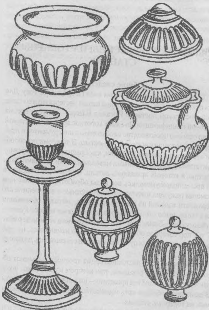
Рис. 23. Предметы, изготовленные на токарных станках
