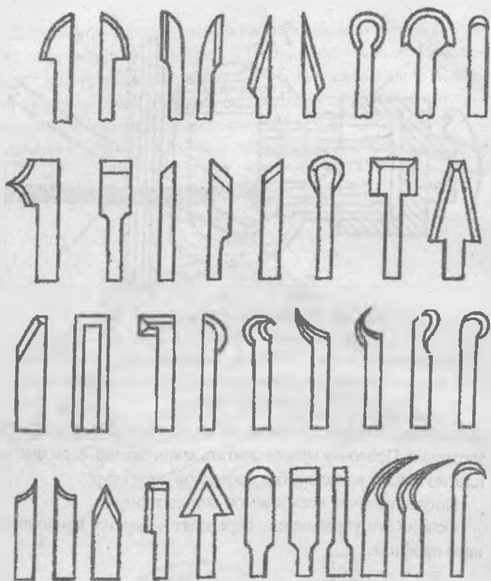
Рис. 49. Фасонные резцы, применяемые при выточке и расточке отверстий и полых форм
