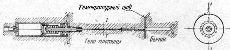
Фиг. 9. Струнный щелемер проф. Ю. А. Нилендера.
